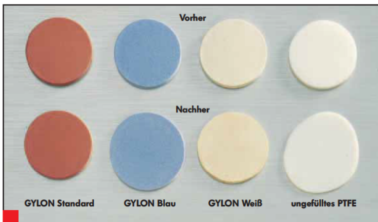
GYLON mit deutlich reduziertem Kaltfluss. Der beste Widerstand gegen Deformationen - ein Vergleich zwischen GYLON Dichtungen und PTFE bei einer Kompression mit 140 Bar über 1 Stunde bei einer Temperatur von 260 °C (mit 14 N/mm 2 ).
